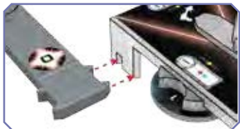
Collocazione dello Strumento di Manovra
